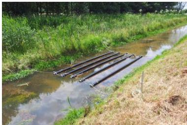
Der Wasserverband Rivierenland testete ein System, mit dem man nährstoffreiche Gräben reinigen kann. Stickstoff und Phosphat werden dabei auf natürliche Weise durch Mikroorganismen gebunden und aus dem Wasser heraus gefiltert.
