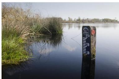
In der Schwalm wurde in unmittelbarer Nähe der Grenze durch Waterschap Peel und Maasvallei und Schwalmverband ein deutsch-niederländisches Monitoringsystem errichtet, das aus einem Pegel mit Messstation besteht. Die Daten über die Abflussmengen auf der Grenze werden elektronisch direkt an beide Wasserverbände übertragen und ausgewertet.
